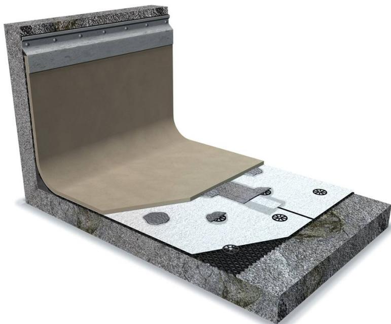
Schematischer Systemaufbau von "MC-FLEX plus"
