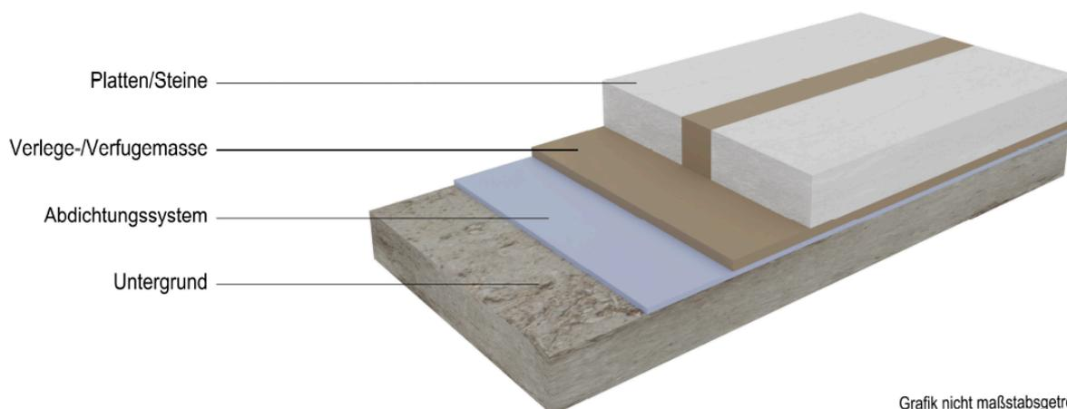
Abbildung 1: Systemaufbau OXYDUR iVE LC PROTECT 1 (nicht ableitfähig) mit Abdichtungssystem OXYDUR iVE LC (Beschichtungssystemvarianten 1 und 2) und Kittsystem OXYDUR iVE M
