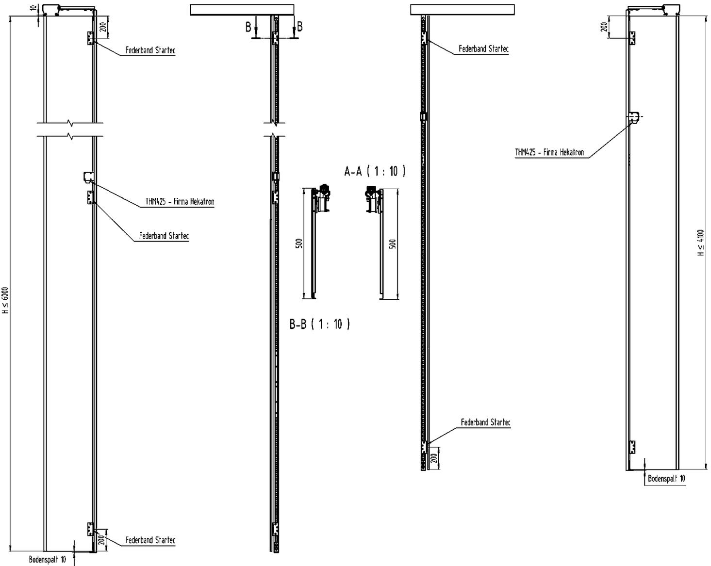
Ein- und Auslaufklappe "NSI Flap W" als Seitenklappe in Verbindung mit Feuer- und Rauchschutzabschlüssen
