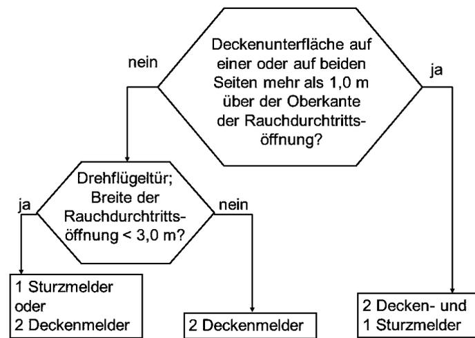
Bild 3: Entscheidungsdiagramm
