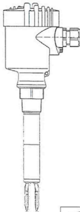
**Schema der Überfüllsicherung**
