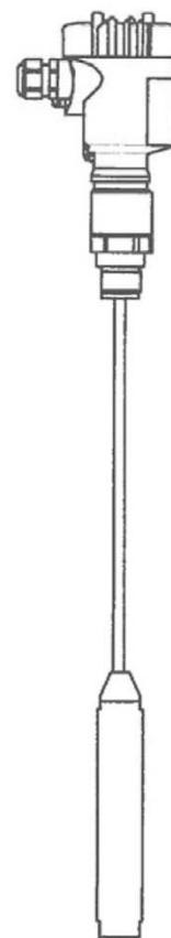
Schema der Überfüllsicherung
