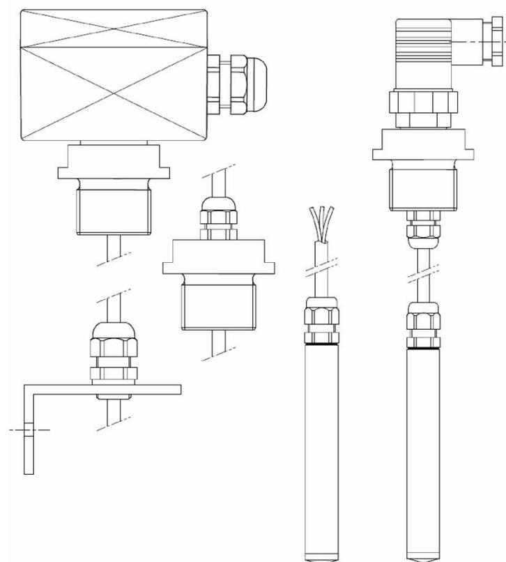
**Schematischer Aufbau der Überfüllsicherung**
