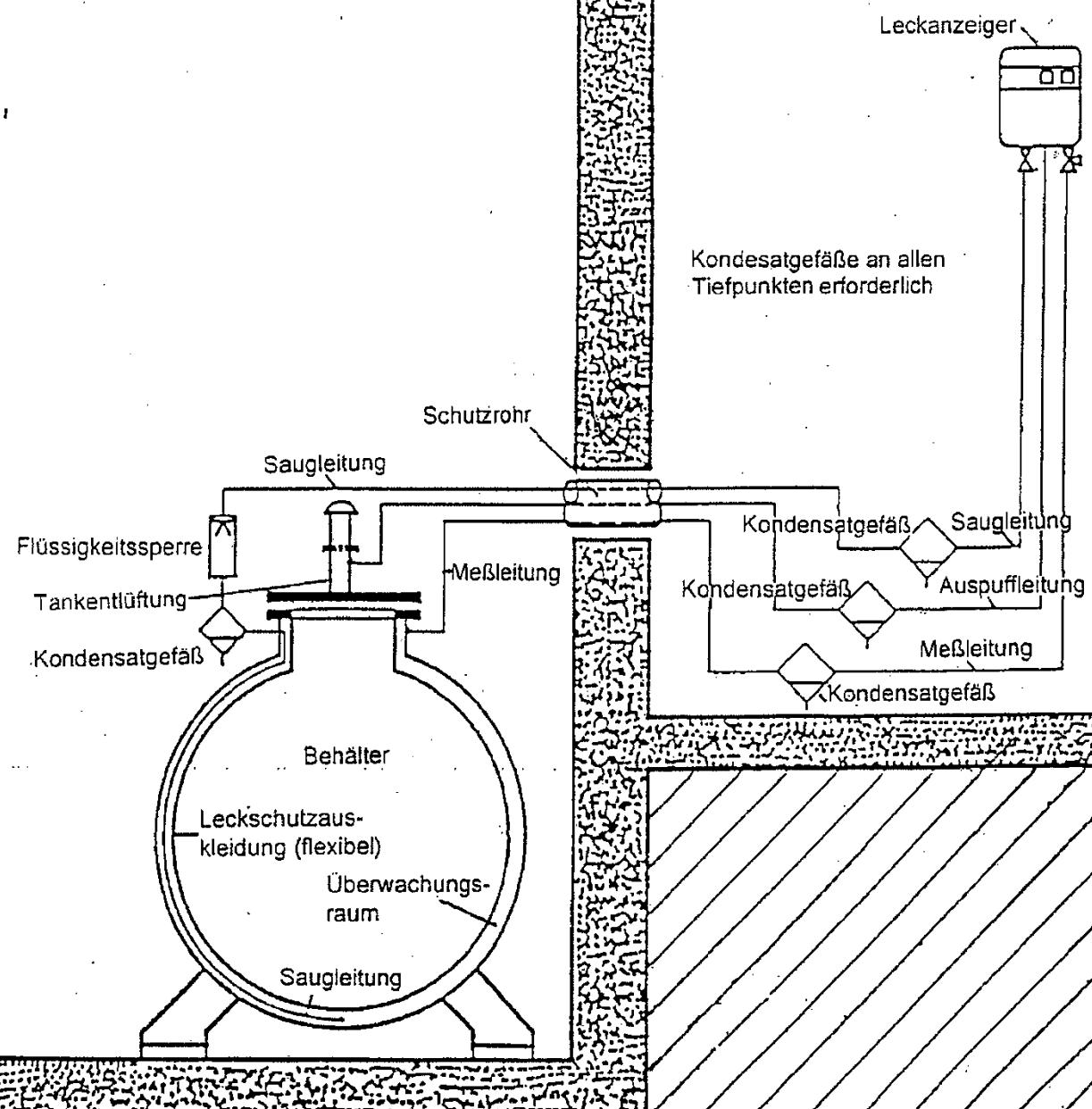
Leckschutzauskleidung vom Typ "AK-S" als Teil eines Leckanzeigesystems für Behälter zum Lagern von Dieselkraftstoffen und Ölen
