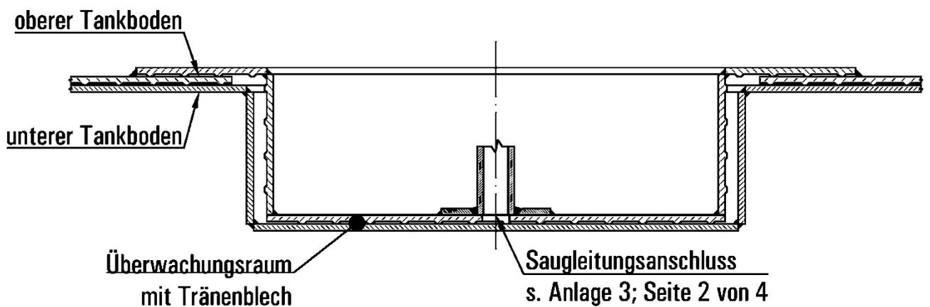
Leckschutzauskleidungen aus Stahl Typ STR-B und Typ STR-T für Flachbodentanks
