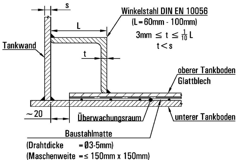
Leckschutzauskleidungen aus Stahl Typ STR-B und Typ STR-T für Flachbodentanks
