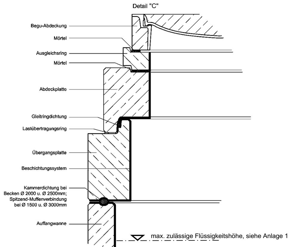
Auffangbecken "NeutraHav" zur Verwendung in Anlagen zum Lagern, Abfüllen und Umschlagen (LAU-Anlagen) wassergefährdender Stoffe
