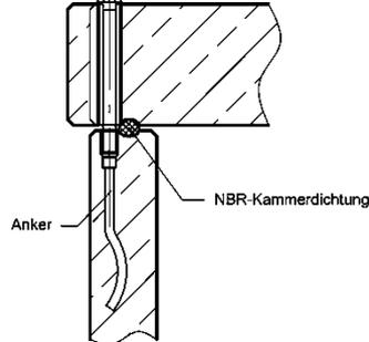
Detail "A" und "B" in Bezug zu Anlage 1 bzw. Anlage 2
