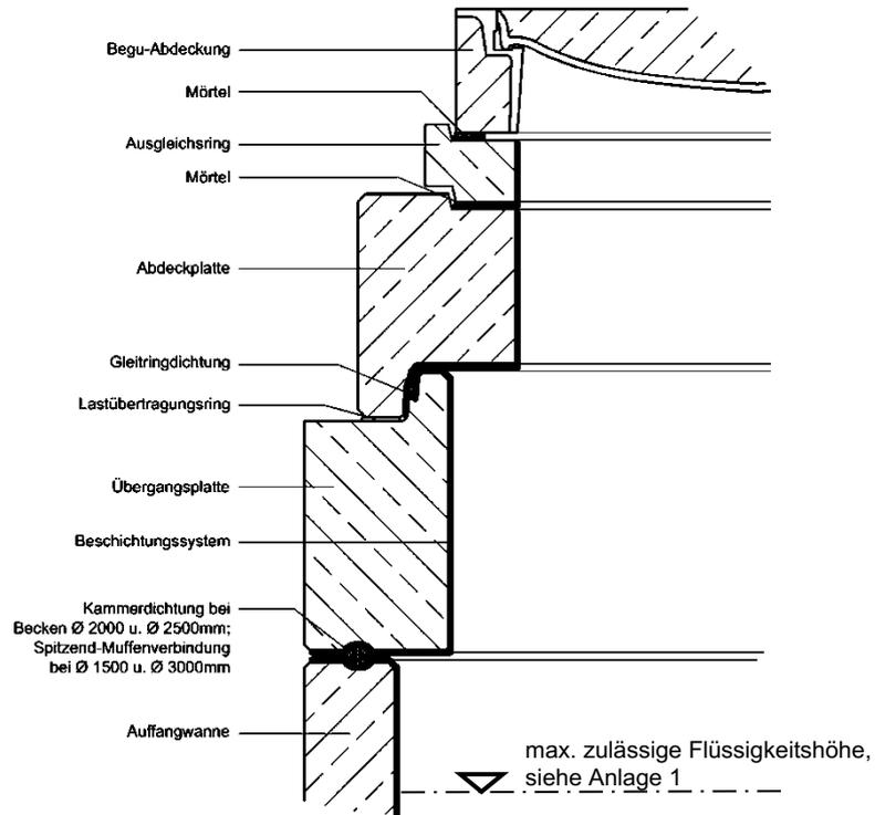
Sicherheitsauffangbecken "NeutraSab" zur Verwendung in Anlagen zum Lagern, Abfüllen
