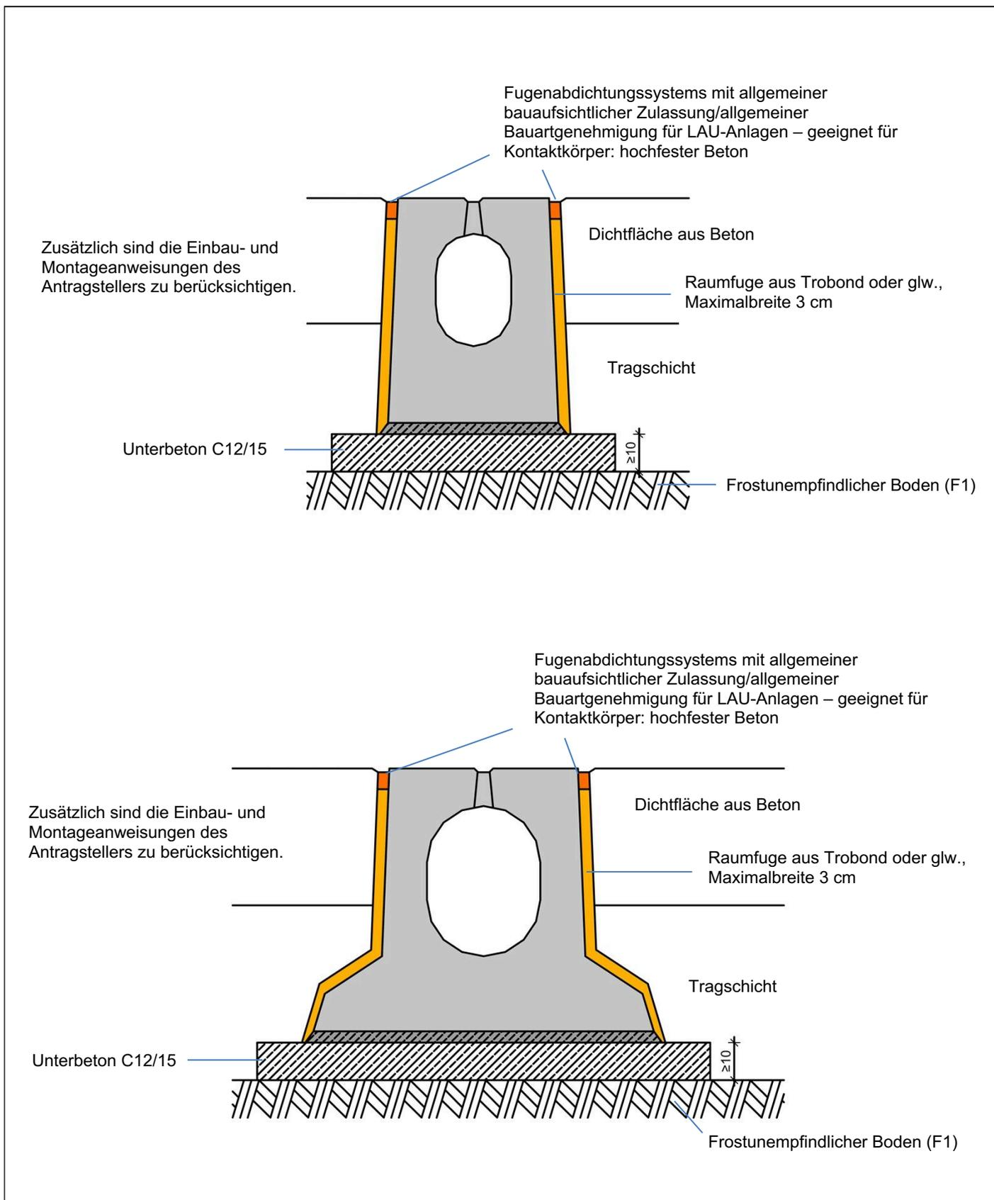
RIKI-CETON-SMART-Schlitzrinnensystem für die Verwendung in LAU-Anlagen
