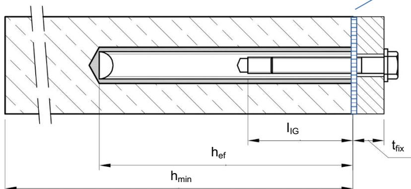
$t_{fix}$  = Dicke des Anbauteils
