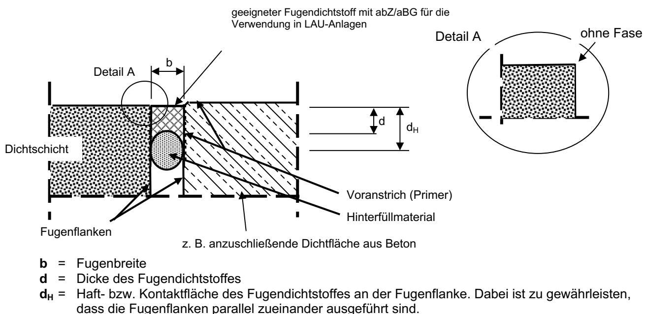
DEUGUSS-W Gussasphalt-Dichtschicht zur Verwendung in LAU-Anlagen
