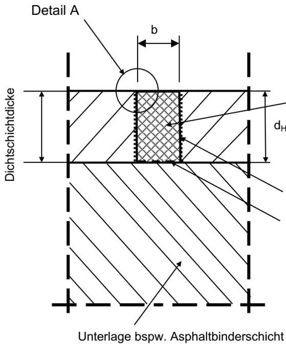
Fugendichtstoff bzw. Fugendichtmasse, der geeignet ist und über eine allgemeine bauaufsichtliche Zulassung/allgemeine Bauartgenehmigung für die Verwendung in JGS-/Biogasanlagen verfügt.
