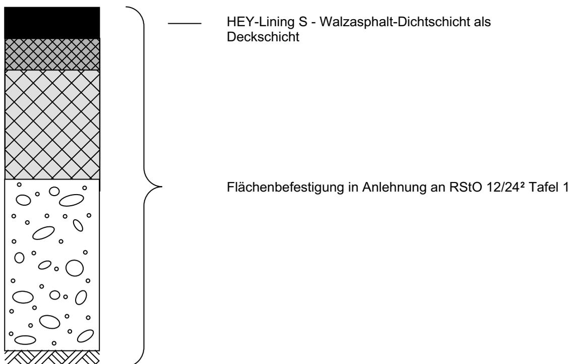
HEY-LINING S - Walzasphalt zur Verwendung für Lager- und Abfüllflächen in JGS-Anlagen und Biogasanlagen
