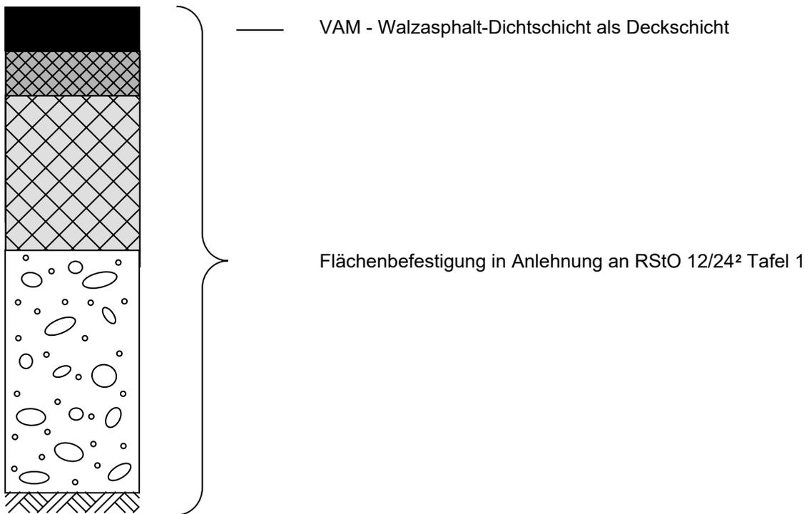
VAM - Walzasphalt-Dichtschiicht zur Verwendung für Lager- und Abfüllflächen in JGS-Anlagen und Biogasanlagen
