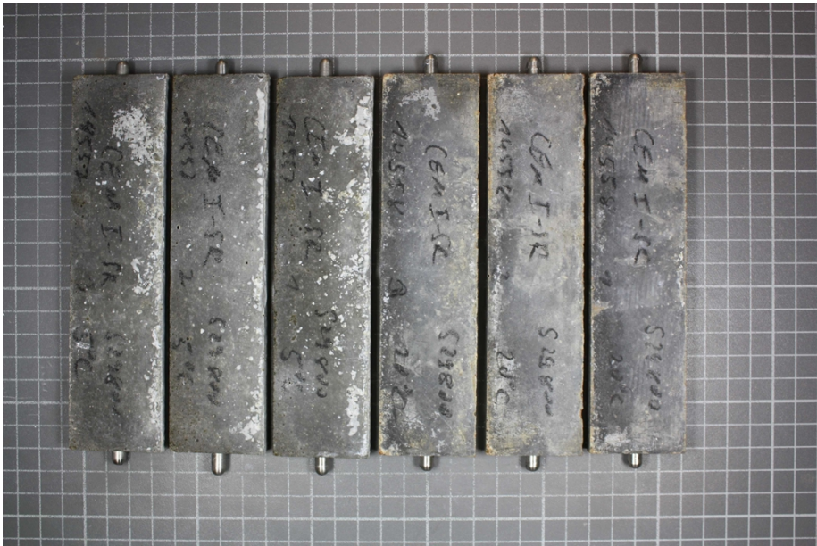
Bild A4: Probekörper mit CEM I 42,5 R-SR3 nach 180 Tagen; Lagerung: in Na 2 SO 4 -Lösung bei 5 °C (3 linken Probekörper) und bei 20 °C (3 rechten Probekörper)
