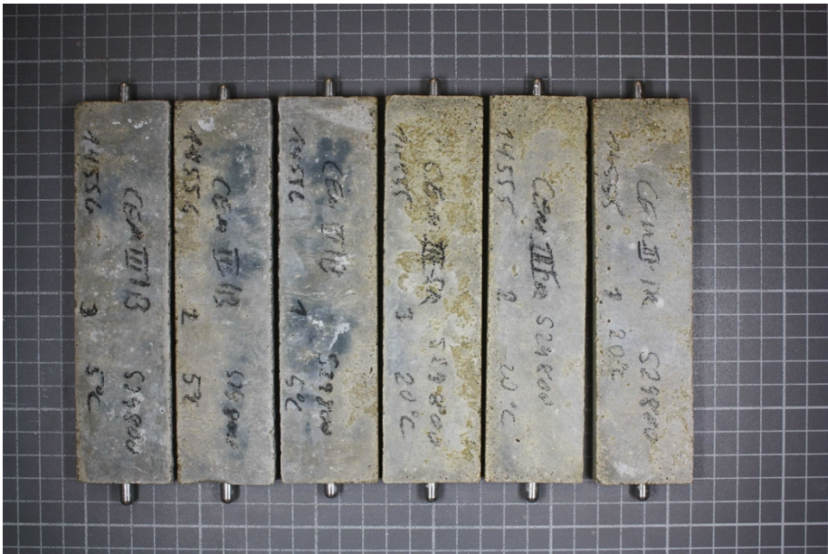
Bild A3: Probekörper mit CEM III/B 42,5 N-LH/SR nach 180 Tagen; Lagerung: in Na 2 SO 4 -Lösung bei 5 °C (3 linken Probekörper) und bei 20 °C (3 rechten Probekörper)
