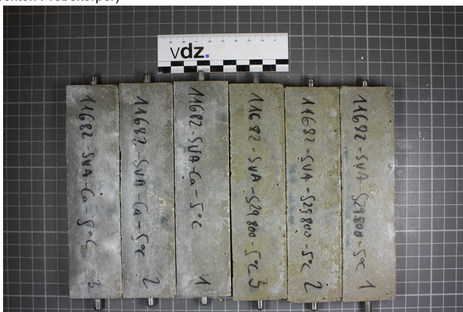
Bild A2: Probekörper aus CEM III/A 52,5 N-SR "Rotterdam" nach 180 Tagen; Lagerung: 5 °C in \text{Ca}(\text{OH})_2 -Lösung (3 linken Probekörper) und \text{Na}_2\text{SO}_4 -Lösung (3 rechten Probekörper)
