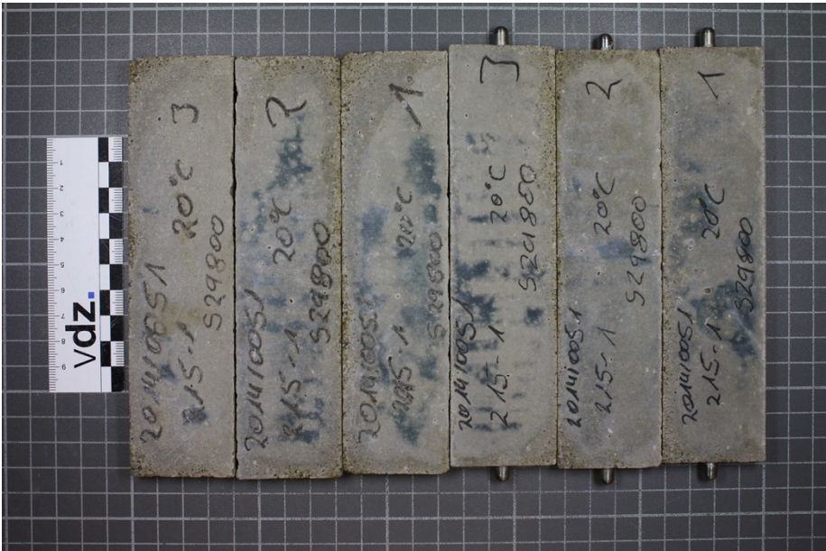
Bild 1: Probekörper aus CEM III/A 52,5 N-SR/LA (Z1 mit Hüttensand 1 (S1)) nach 180 Tagen; Lagerung: 20 °C in Na 2 SO 4 -Lösung
