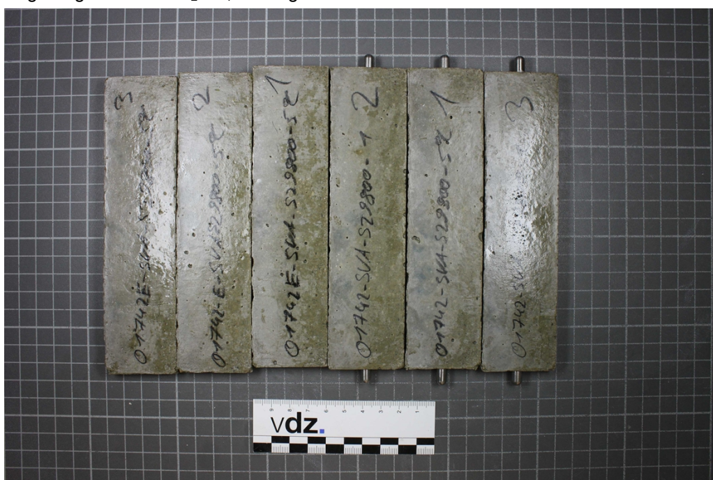
Bild 6: Probekörper aus CEM III/A 52,5 N-SR/LA (Z2 mit Hüttensand 2 (S2)) nach 180 Tagen; Lagerung: 5 °C in Na 2 SO 4 -Lösung
