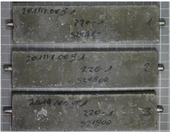
Bild 4: Probekörper aus CEM I 42,5 R-SR3 nach 180 Tagen; Lagerung: in Na 2 SO 4 -Lösung bei 20 °C (links) und 5 °C (rechts)
