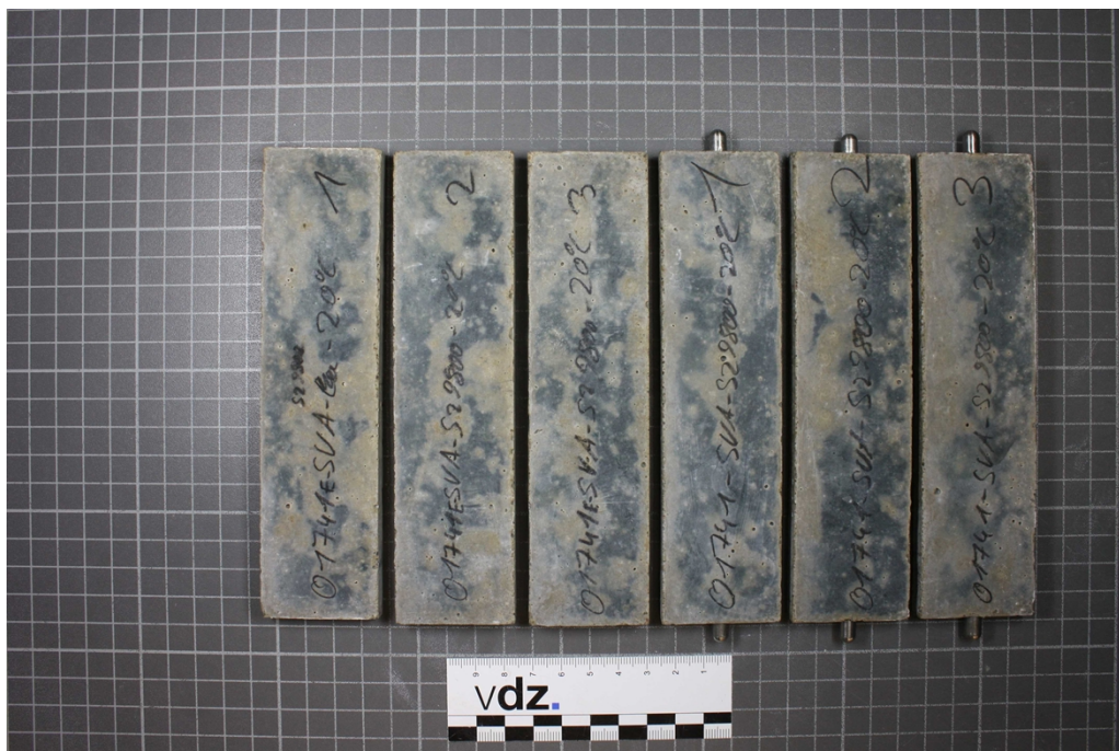
Bild 5: Probekörper aus CEM III/A 52,5 N-SR/LA (Z2 mit Hüttensand 2 (S2)) nach 180 Tagen; Lagerung: 20 °C in Na 2 SO 4 -Lösung
