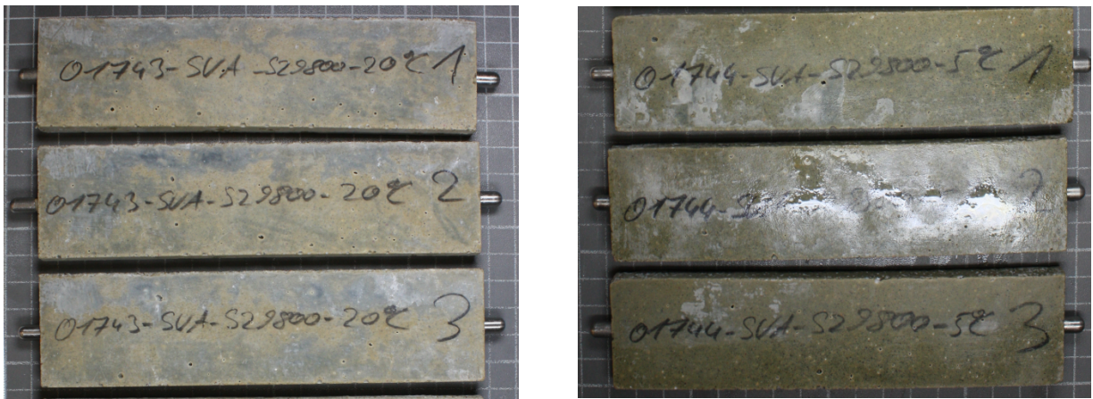
Bild 7: Probekörper aus CEM III/B 42,5 N-LH/SR nach 180 Tagen; Lagerung: in Na 2 SO 4 -Lösung bei 20 °C (links) und 5 °C (rechts)
