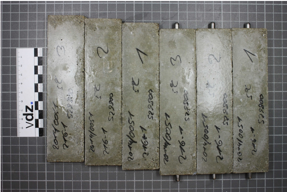
Bild 2: Probekörper aus CEM III/A 52,5 N-SR/LA (Z1 mit Hüttensand 1 (S1)) nach 180 Tagen; Lagerung: 5 °C in Na 2 SO 4 -Lösung
