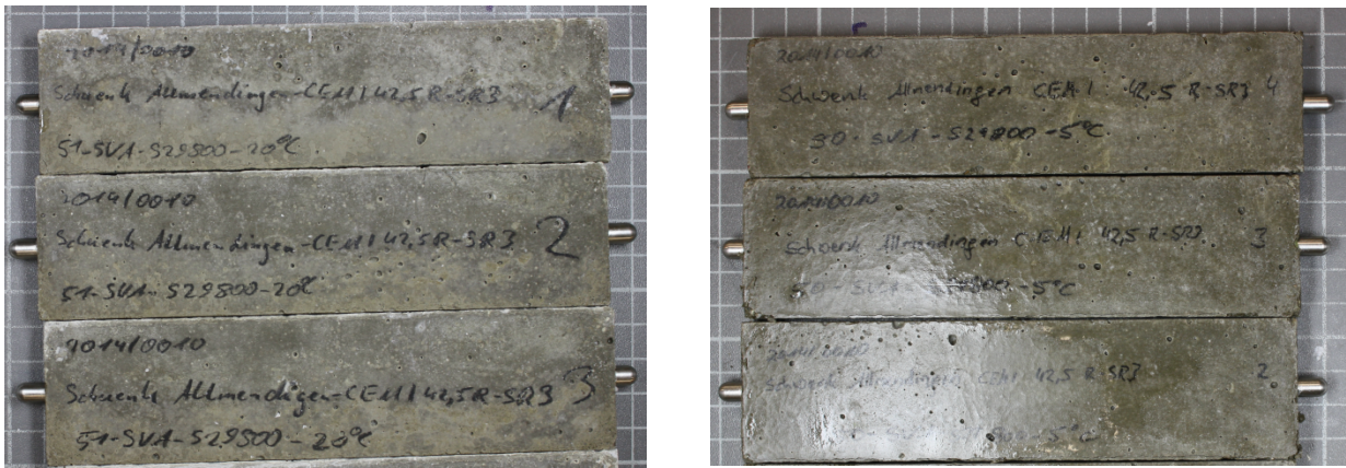
Bild 8: Probekörper aus CEM I 42,5 R-SR3 nach 180 Tagen; Lagerung: in Na 2 SO 4 -Lösung bei 20 °C (links) und 5 °C (rechts)
