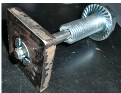
Abbildung 2: Montierter Molabolt nach Zugversuch
