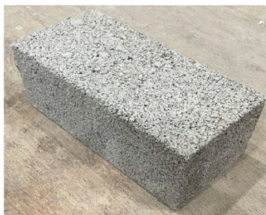
Vollblock aus Leichtbeton nach DIN EN 771-3:2015-11
