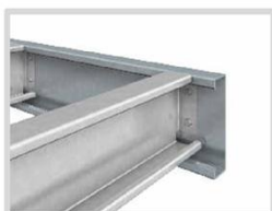
Anschluss des Nebenträgers an der Innenseite des Hauptträgers
