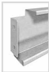
Anschluss des Nebenträgers an der Innenseite des Hauptträgers
