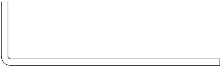
▲ Wandanschluss-Befestigungswinkel, Variante 1 ZSR2150, Abm. 29x100x3
