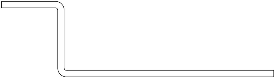
▲ Wandanschluss-Befestigungswinkel, Variante 2 ZSR2150, Abm. 29x35x100x3
