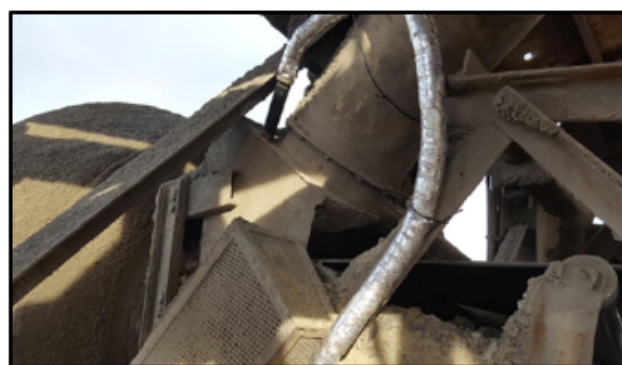
Abb. 3: Positionierung der Einspritzdüse an einem zentralen Mischer
