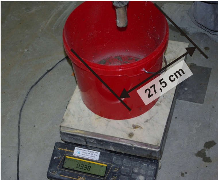
Bild 4: Versuchsanordnung zur Einstellung des Mantelluft-Drucks
