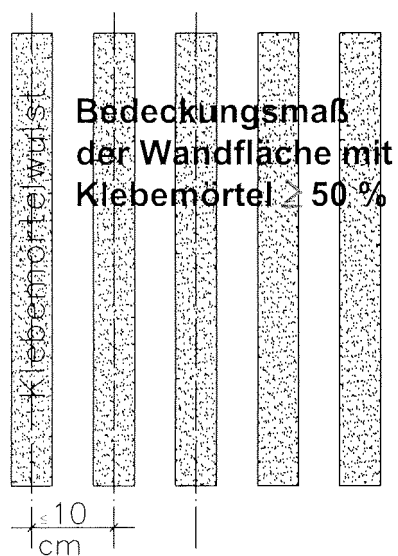
Teilflächenverklebung gemäß Abschnitt 3.2.4.4
