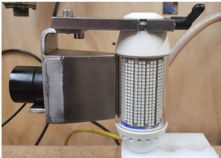
Bild 2: Intensitätsmessung an einem LED-Streifen
