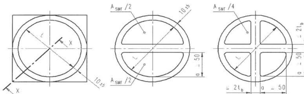
Abb. B.2 - Beispiele für die Ausbildung gekammerter ebener SMF-Platten
