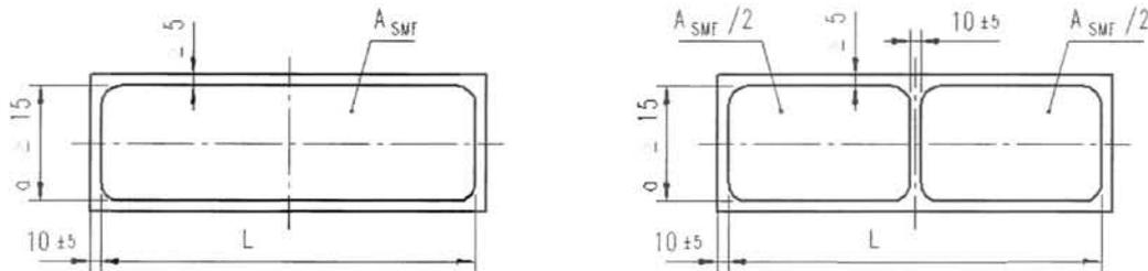
Abb. B.4 - Beispiele für gekammerte SMF-Platten für Führungen
