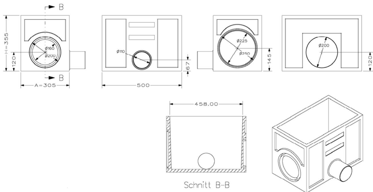
"SL-Block NW 200" Schlitzrinnensystem für die Verwendung in LAU-Anlagen
