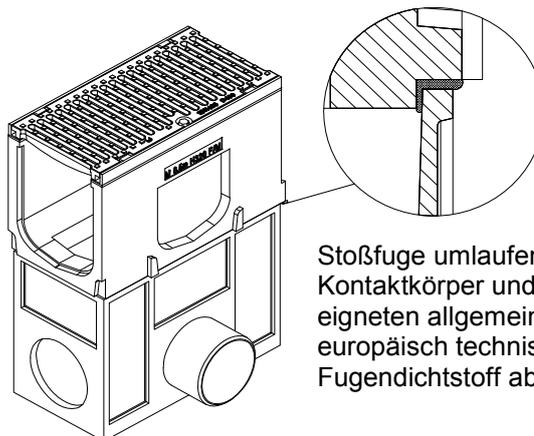
Stoßfuge umlaufend mit einem für den Kontaktkörper und die Verwendung geeigneten allgemein bauaufsichtlich bzw. europäisch technisch zugelassenen Fugendichtstoff abdichten.
