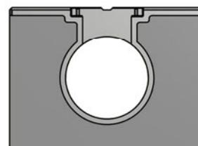
Schnitt durch Revisionsöffnung und Ablauf
