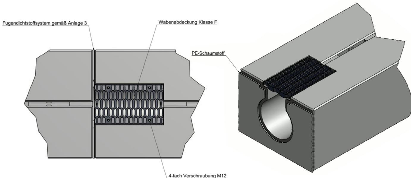
**Fugendimensionierung** zwischen den Rinnenfertigteilen und zwischen der anschließenden Dichtkonstruktion und den Rinnenfertigteilen
