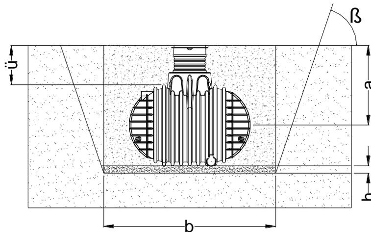
**a** = Abstand Geländeoberkante bis zu höchstem Grundwasserstand
