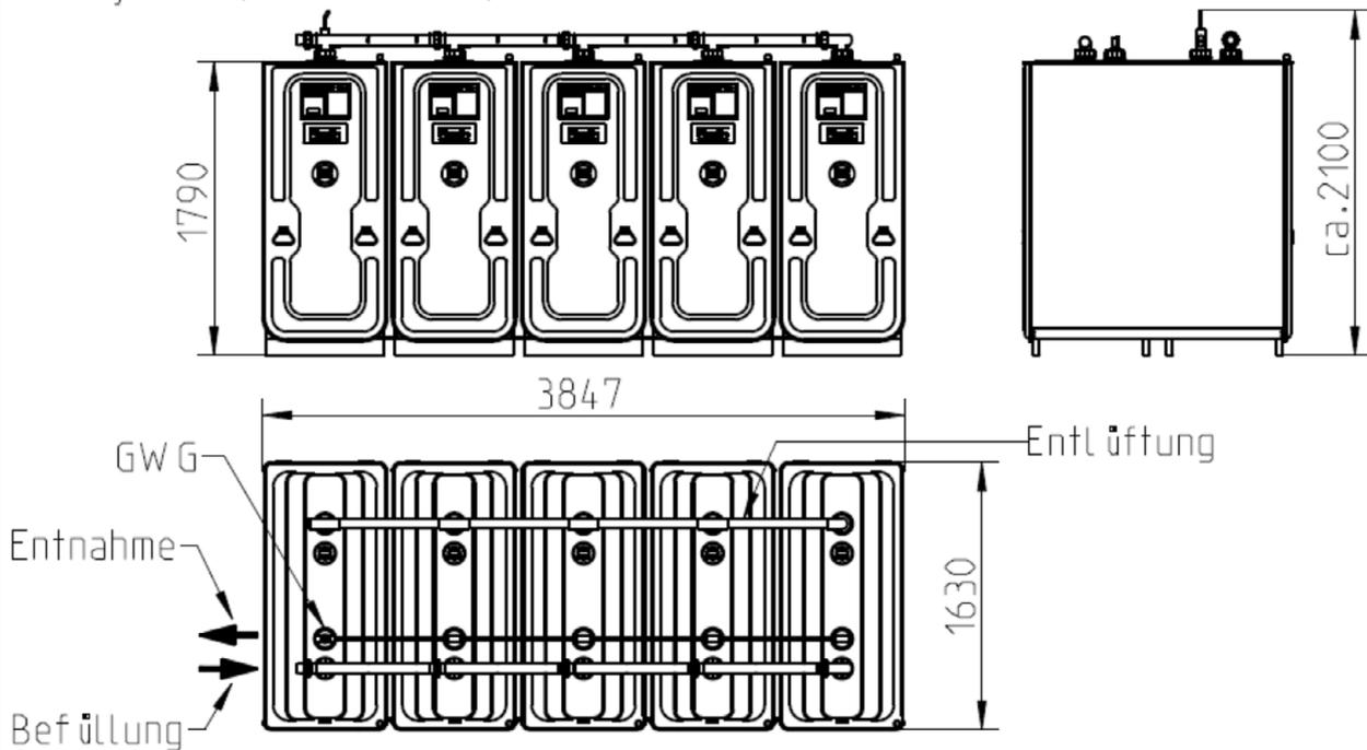
Blasgeformte Behälter aus Polyethylen (PE-HD)
