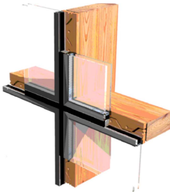
Horizontalschnitt (durch Pfosten)
