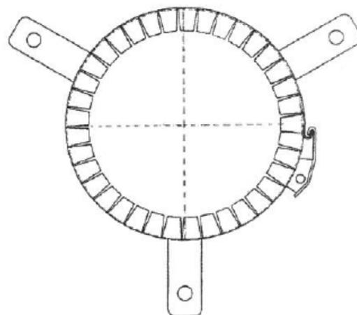
Rohrmanschette für feuerwiderstandsfähige Abschottungen "REHAU Kompakt"
