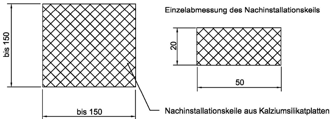
Mindestabstand von Keil zu Keilblock und zu den Bauteillaubungen  $\geq 50$  mm
