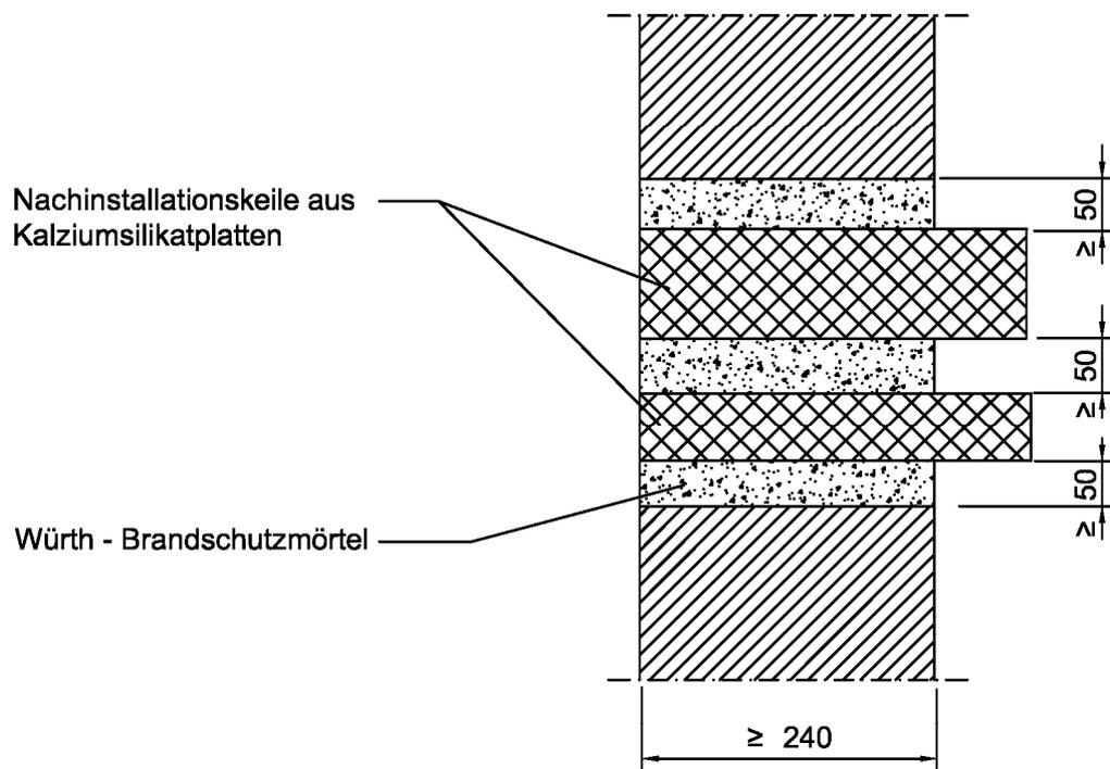
**Maximale Abmessungen des mit Nachinstallationskeilen verschlossenen Schottbereichs**
